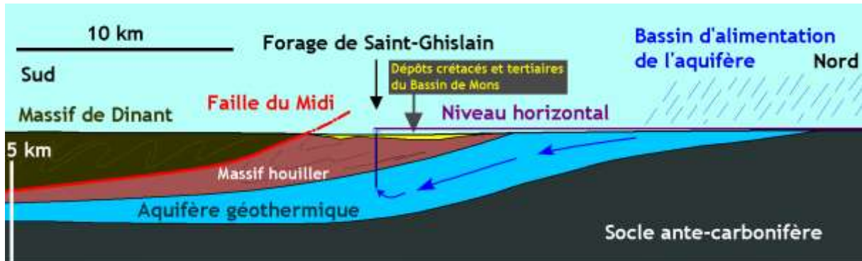
Figure 2 : L'aquifère géothermique du Hainaut. Cette figure est une coupe géologique interprétative orientée du nord vers le sud, à partir des données géologiques récoltées en affleurement, des forages et des investigations géophysiques. Les formations formant l'aquifère géothermique sont formées des calcaires, dolomies et anhydrites datant du Carbonifère inférieur. Elles reposent sur le socle primaire ante-carbonifère et sont surmontées par les formations du Carbonifère supérieur. Les eaux sont artésiennes au niveau des sondages forés dans le Bassin de Mons, étant à une altitude inférieure à la zone d'alimentation de l'aquifère.
