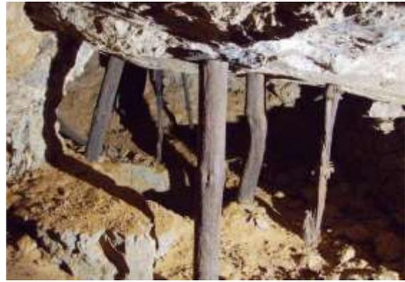
Figure 2 : Boisage - Mine de zinc, plomb, argent, cadmium - Gard
